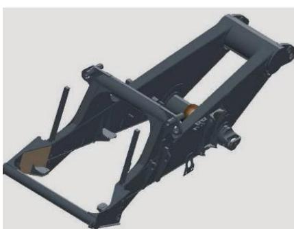
Okvir ima ravnu šinu i bešavne cijevi poprečne grede kako bi se eliminirali izvori koncentracije naprezanja. Glavne šine varijabilnog presjeka smanjuju naprezanje i povećavaju vijek trajanja okvira. Poprečna struktura bešavnih cijevi povećava otpornost na torziju. Proces potopnog elektrolučnog zavarivanja dodatno smanjuje naprezanje sa zavarenim spojevima s punim prođorom, što povećava vijek trajanja okvira.
